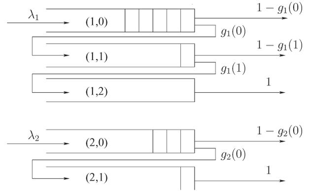
Fig. 2. LPAK-system model.
